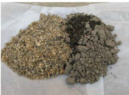
図 9.1 含水比 9%の砂（左）と同じ含水比の水田土（右）を接触させたときの様子。
