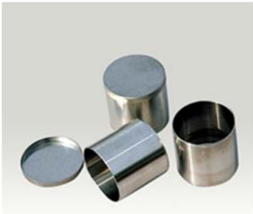
図 10.4 一定体積の土壌試料採取用ステンレス円筒。100 mL 容。
